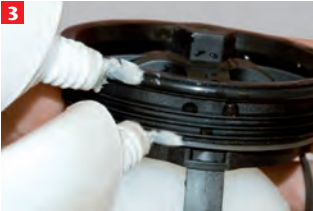
3 Dichtungen an der Rückstaeinheit einfetten
